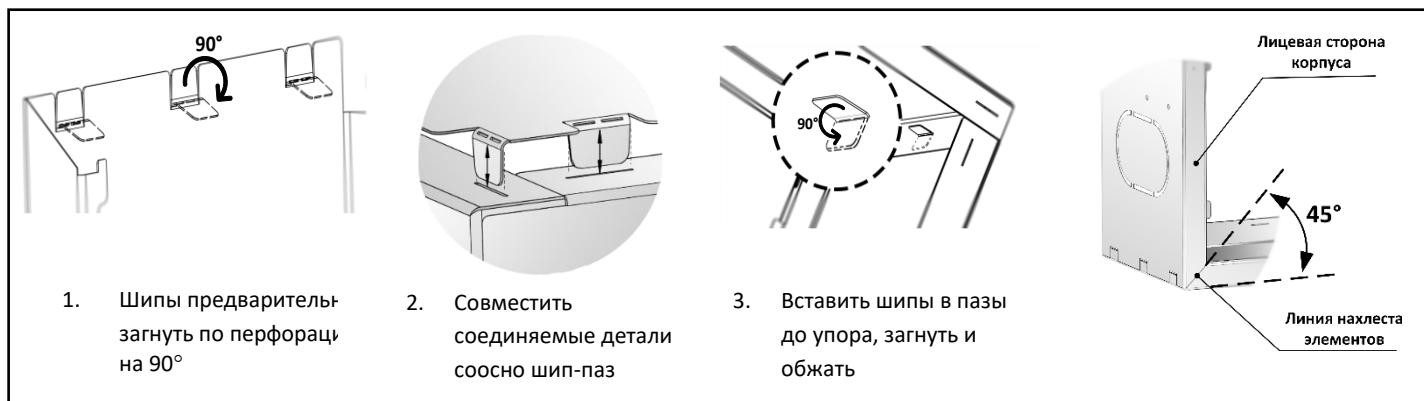
Рис.1 Соединение шип-паз, контроль сборки.
